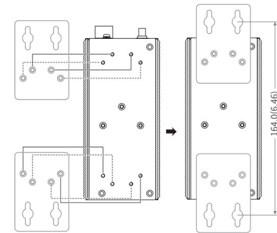
3. 将路由器壁挂安装在墙上需要4个螺钉。螺钉的头部直径应小于6毫米，轴的直径应小于3.5毫米，如下图所示。使用安装好壁挂件的路由器，标记4个螺钉的正确位置。
