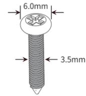
4. 在固定螺钉到墙体之前，请将螺钉插入壁挂件的一个锁孔中，确保螺钉头和柄的尺寸合适。固定螺钉到墙体时，不要将螺钉完全拧进去，需留出2毫米左右的空间，以便在墙体和螺钉之间滑动壁安装面板。
