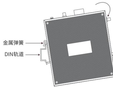
2. 将DIN导轨座单元迅速旋转按入如下图所示位置。
