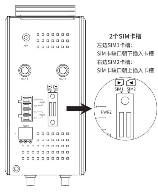
图 1-11 4G无线路由器SIM卡槽
